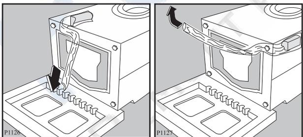
8. Установите нижнюю панель машины на место, так, чтобы язычок попал в желоб.
